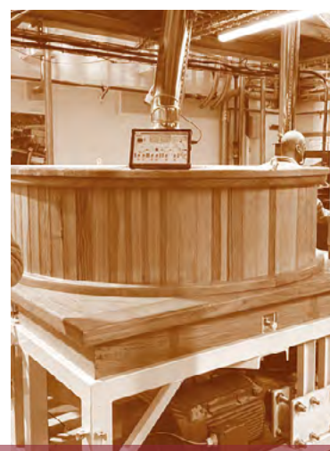
Nouvelles meules de pierre installées à Verdelot en 2024
