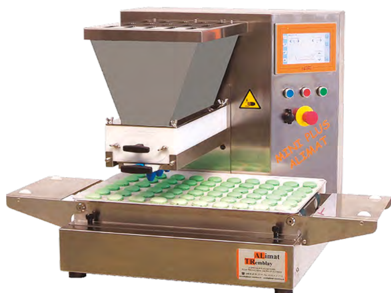
La dresseuse-pocheuse « mini plus » d'Alimat Tremblay
